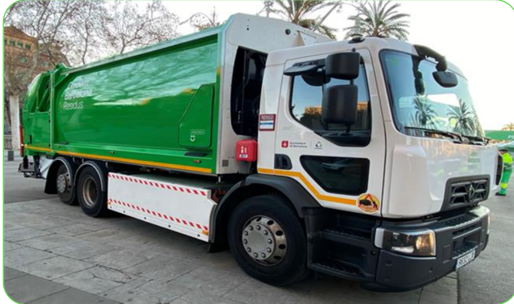
Recol·lector compactador de càrrega posterior Motor: 100% Elèctric
