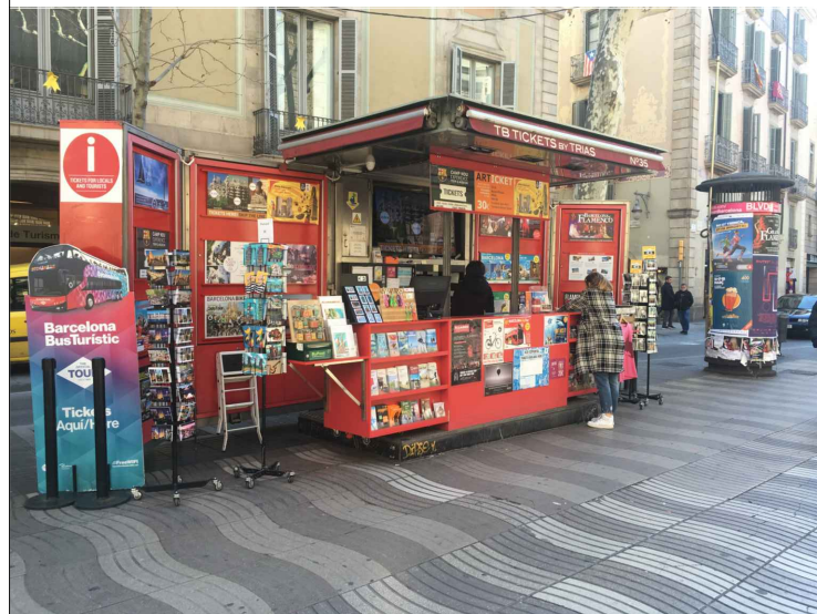
■ Qi1_quiosc d'informació turística (ex ocellaires)_01 unitat alçat principal (autor: Moragas Spa_concurs 1997) dimensions: 3 x 2,5m tancat / 2,5 x 7,5m obert - excessiva ocupació més enllà de l'espai del quiosc - mala relació amb els elements de l'entorn (fanals, arbres, etc)
