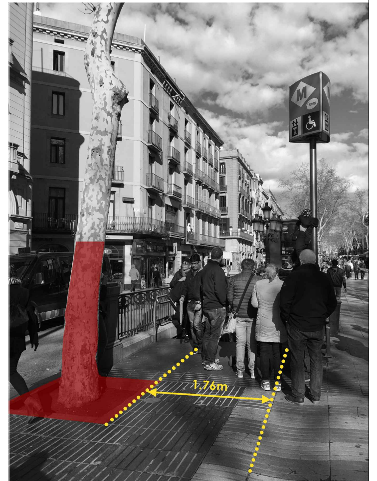
A8_Accés Metro Liceu (Problemes d'accessibilitat_accés metro)
