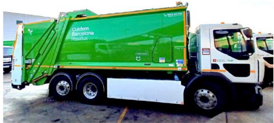
Recol·lector elèctric de càrrega posterior bicompartimentat de 20 m 3 Recollida de totes les fraccions i bujols dels carrers més amples
